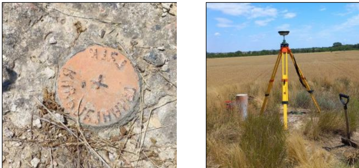
Рисунок 2. Состояние марки (а) и сверка координат с помощью GNSS-приемника (б)
