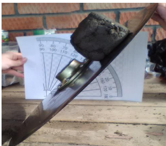
Рисунок 1. Проведение эксперимента по определению коэффициента внешнего трения
