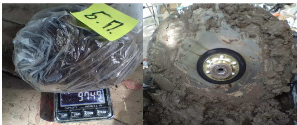
Рис. 3. Масса счищенной почвы с диска без покрытия при влажности 18%
