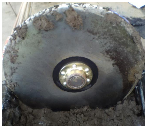
Рисунок 4. Налипание почвы на диск с фторопластовым покрытием при влажности 18%
